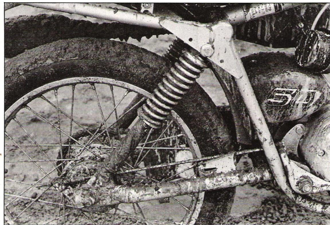
Tunturin takajousitusta voi säätää vain elementtien kulmaa muuttamalla, kätevä jousen esijännityksen säätö puuttuu.
